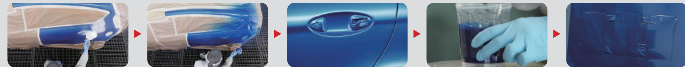
5 기존 도장면과 작업면이 자연스럽게 블렌드-인 될 수 있도록 블렌드-인 첨가제 1051도포 6 조색된 베이스코트를 작업면에서 먼저 도장된 블렌더 부위 가장자리까지 도포 7 완전 건조까지 플레시 오프 8 스피스헥커 색상 첨가제를 색상 배합 및 적용하고자 하는 투명 제품에 따라 알맞게 섞어줌 9 도장 전, 보다 정확한 컬러 매칭을 위해 컬러 시편 작업을 통한 틴티드 클리어의 도장 두께에 따른 색상 차이를 확인하는 것이 좋음
