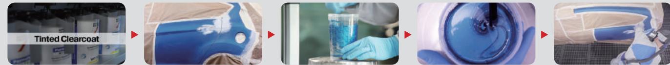
틴티드 클리어 코트 적용 방법 1 작업 부위 준비 2 색상 배합 정보에 따라 조색 3 해당 색상 베이스코트 준비 4 작업 부위 표면의 먼지와 샌딩 입자 제거
